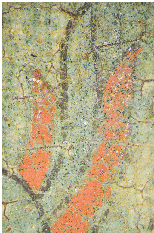
Рис. 10. «Собор избранных святых». Макросъемка позыма с растительным элементом. В составе колера видны крупные частицы глауконита.
