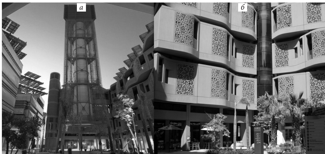
Рис. 7. Башня ветра (а) и решетки машрабии (б) кампуса Университета Науки и Технологии Масдара, Абу Дабби, ОАЭ. Арх. Норман Фостер. 2007–2010 гг.
